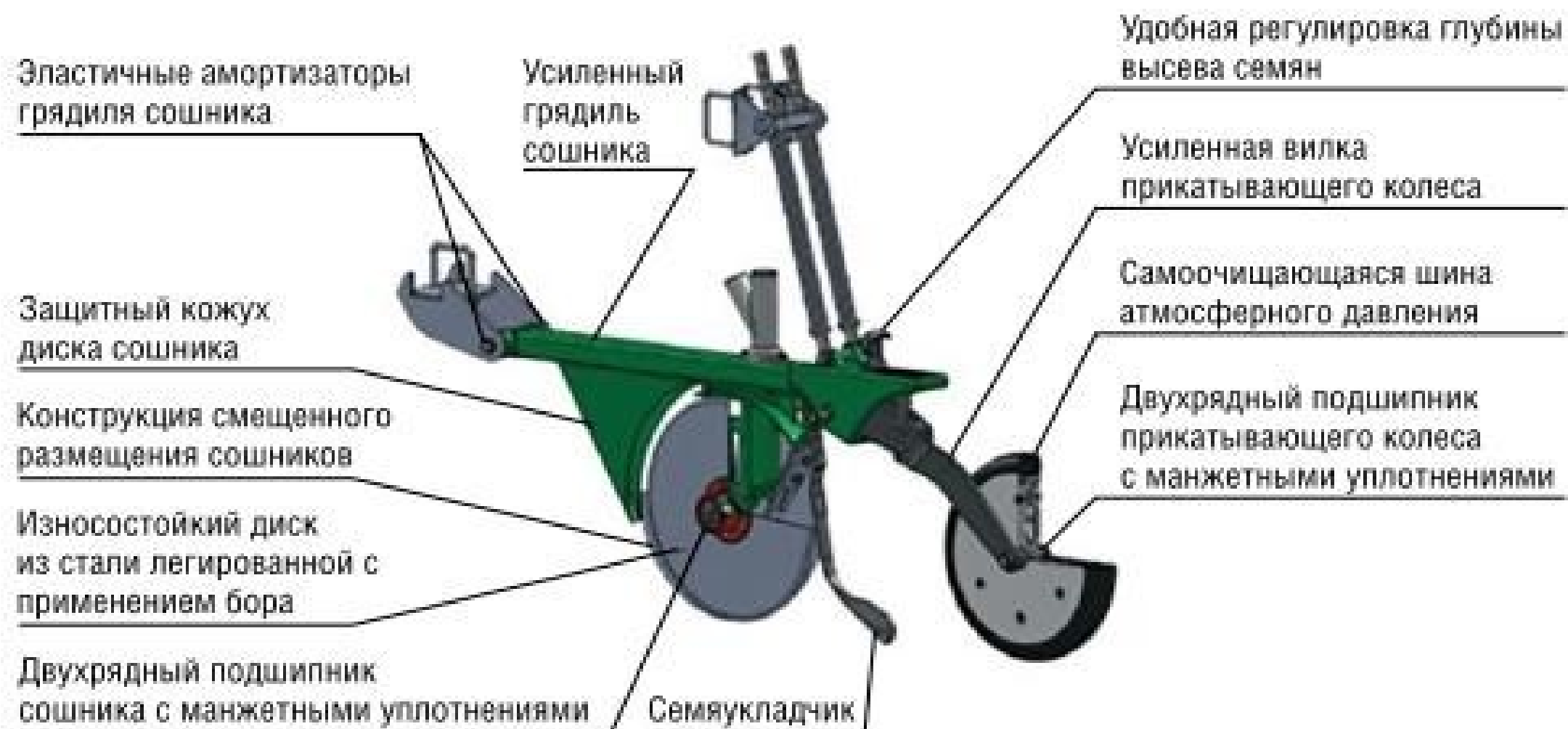
Устройство сошника дисковой сеялки.
